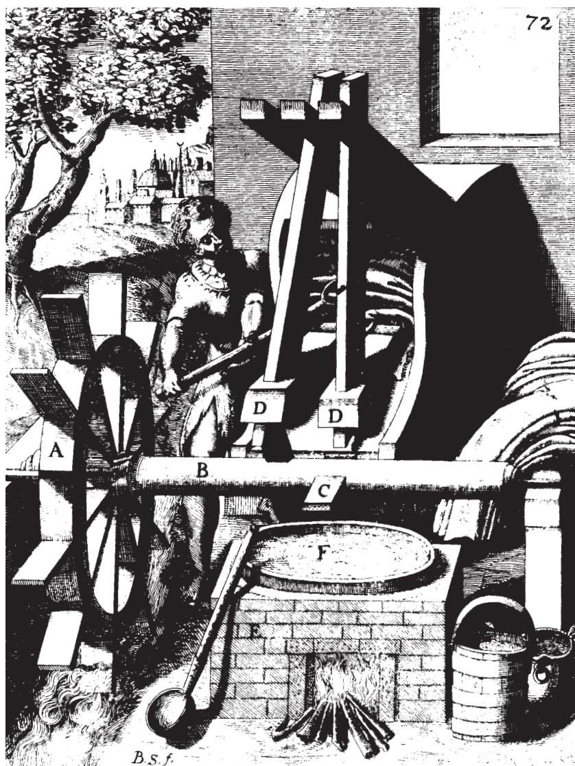
Fig. 4 Mulino per feltrare panni (tratta da R.D. HENRICI SCHMITZ, Theatrum machinarum novum , Colonia, 1662, p. 72)
