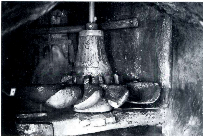
FIG. 6. — Ruota idraulica orizzontale del mulino « della sorgente solfurea » in località Guinza (comune di Mercatello sul Metauro). Sono chiaramente visibili facendo riferimento al disegno della figura 3 oltre all'albero motore, in basso il piano d'appoggio (a), la leva (b) e il ceppo della ralla (7). Sullo sfondo la « saracina » (2) e le sue leve (3).
