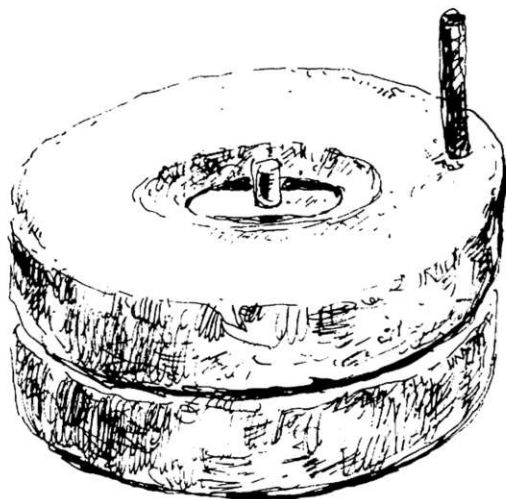
FIG. 3 - Macina a mano per cereali ancor oggi usata in Palestina (da GLAZER, rielaborato)
