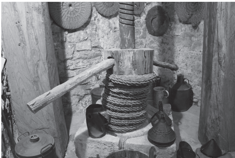
Fig. 9 Ricostruzione moderna ipotetica di un torchio a vite diretta che ha funzionato veramente fino agli anni '40 del 1900
